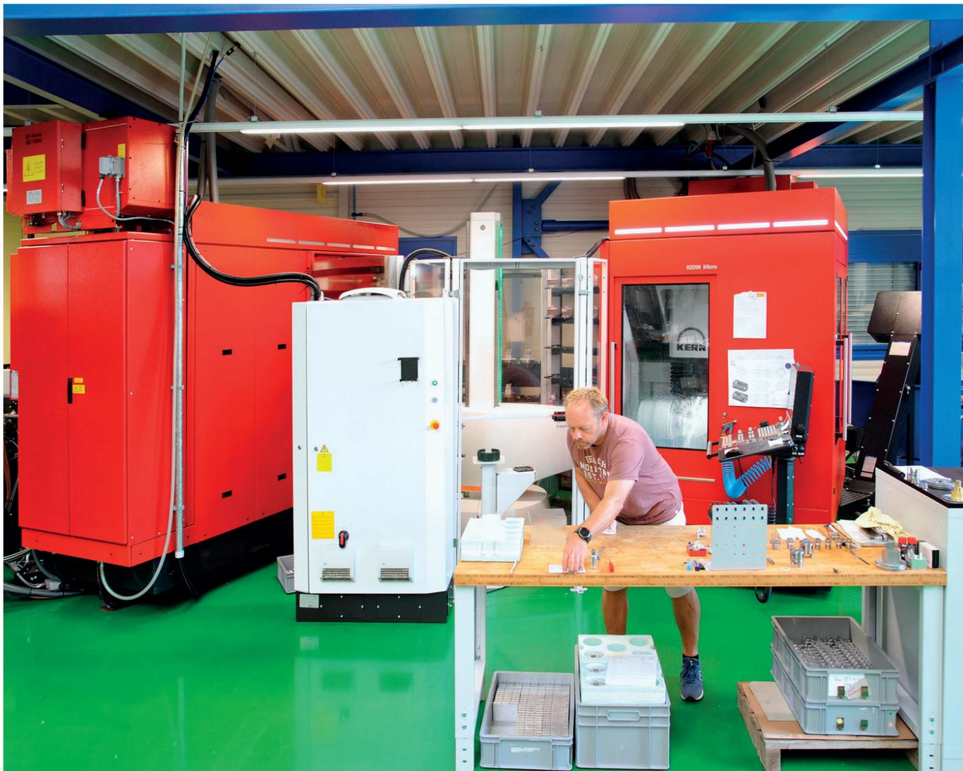
**Bild 1:** Die zwei Fräszentren KERN Micro hat Werner Buschor so platziert, dass beide von einem Werkstückwechsler in der Mitte bedient werden können
